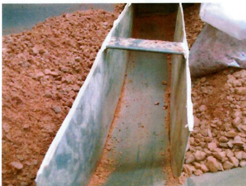
Figura 8 – Gabarito construído para retirada do material remanescente.
