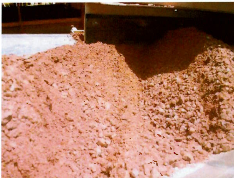
Figura 7 – Material remanescente no transportador de correia após o corte do amostrador.
